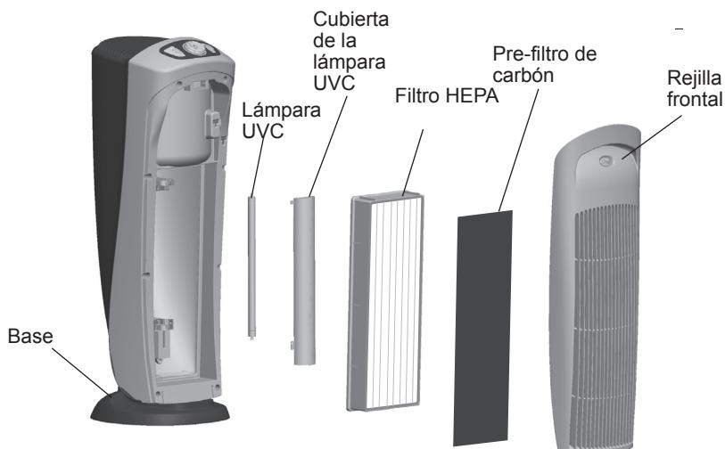
Fig. 2 - Componentes del purificador de aire
